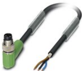
Sensor-/Aktor-Kabel, 3-polig, PUR halogenfrei, schwarzgrau RAL 7021, geschirmt, Stecker gewinkelt M8, auf freies Leitungsende, Kabellänge: 3 m
