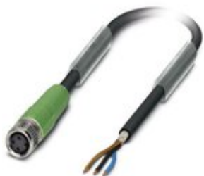
Sensor-/Aktor-Kabel, 3-polig, PUR halogenfrei, schwarzgrau RAL 7021, geschirmt, freies Leitungsende, auf Buchse gerade M8, Kabellänge: 3 m
