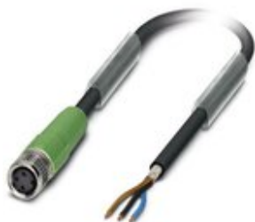
Sensor-/Aktor-Kabel, 3-polig, PUR halogenfrei, schwarzgrau RAL 7021, geschirmt, freies Leitungsende, auf Buchse gerade M8, Kabellänge: 5 m
