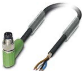
Sensor-/Aktor-Kabel, 4-polig, PUR halogenfrei, schwarzgrau RAL 7021, geschirmt, Stecker gewinkelt M8, auf freies Leitungsende, Kabellänge: 3 m
