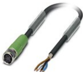
Sensor-/Aktor-Kabel, 4-polig, PUR halogenfrei, schwarzgrau RAL 7021, geschirmt, freies Leitungsende, auf Buchse gerade M8, Kabellänge: 3 m
