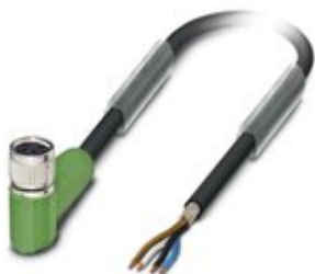
Sensor-/Aktor-Kabel, 4-polig, PUR halogenfrei, schwarzgrau RAL 7021, geschirmt, freies Leitungsende, auf Buchse gewinkelt M8, Kabellänge: 1,5 m
