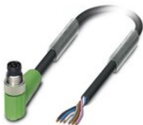
Sensor-/Aktor-Kabel, 6-polig, PUR halogenfrei, schwarzgrau RAL 7021, Stecker gewinkelt M8, auf freies Leitungsende, Kabellänge: 5 m
