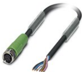
Sensor-/Aktor-Kabel, 6-polig, PUR halogenfrei, schwarzgrau RAL 7021, freies Leitungsende, auf Buchse gerade M8, Kabellänge: 5 m
