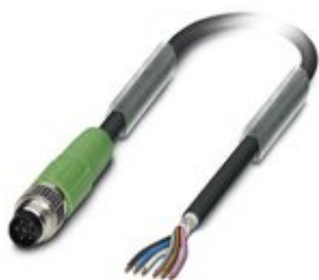
Sensor-/Aktor-Kabel, 6-polig, PUR halogenfrei, schwarzgrau RAL 7021, geschirmt, Stecker gerade M8, auf freies Leitungsende, Kabellänge: 5 m
