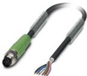
Sensor-/Aktor-Kabel, 6-polig, PUR halogenfrei, schwarzgrau RAL 7021, geschirmt, Stecker gerade M8, auf freies Leitungsende, Kabellänge: 10 m
