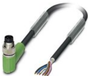
Sensor-/Aktor-Kabel, 6-polig, PUR halogenfrei, schwarzgrau RAL 7021, geschirmt, Stecker gewinkelt M8, auf freies Leitungsende, Kabellänge: 1,5 m, Kundenvariante
