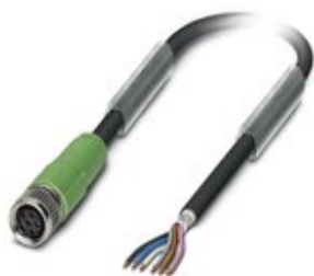
Sensor-/Aktor-Kabel, 6-polig, PUR halogenfrei, schwarzgrau RAL 7021, geschirmt, freies Leitungsende, auf Buchse gerade M8, Kabellänge: 5 m
