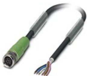
Sensor-/Aktor-Kabel, 6-polig, PUR halogenfrei, schwarzgrau RAL 7021, geschirmt, freies Leitungsende, auf Buchse gerade M8, Kabellänge: 10 m
