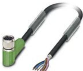
Sensor-/Aktor-Kabel, 6-polig, PUR halogenfrei, schwarzgrau RAL 7021, geschirmt, freies Leitungsende, auf Buchse gewinkelt M8, Kabellänge: 1,5 m
