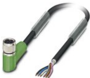
Sensor-/Aktor-Kabel, 6-polig, PUR halogenfrei, schwarzgrau RAL 7021, geschirmt, freies Leitungsende, auf Buchse gewinkelt M8, Kabellänge: 3 m
