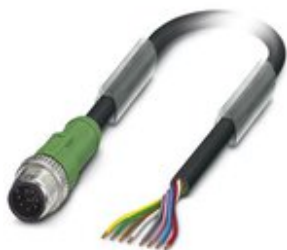
Sensor-/Aktor-Kabel, 8-polig, PUR halogenfrei, schwarzgrau RAL 7021, Stecker gerade M12, Kodierung: A, auf freies Leitungsende, Kabellänge: 5 m
