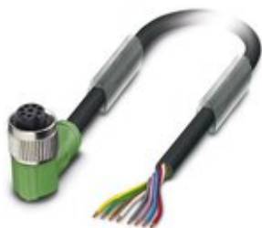
Sensor-/Aktor-Kabel, 8-polig, PUR halogenfrei, schwarzgrau RAL 7021, freies Leitungsende, auf Buchse gewinkelt M12, Kodierung: A, Kabellänge: 5 m
