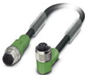
Sensor-/Aktor-Kabel, 8-polig, PUR halogenfrei, schwarzgrau RAL 7021, Stecker gerade M12, Kodierung: A, auf Buchse gewinkelt M12, Kodierung: A, Kabellänge: 3 m
