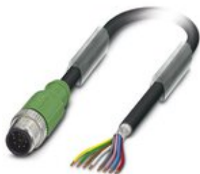
Sensor-/Aktor-Kabel, 8-polig, PUR halogenfrei, schwarzgrau RAL 7021, geschirmt, Stecker gerade M12, Kodierung: A, auf freies Leitungsende, Kabellänge: 3 m
