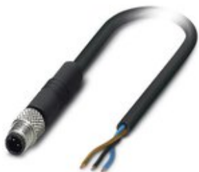
Sensor-/Aktor-Kabel, 3-polig, PUR, schwarz RAL 9005, Stecker gerade M5, Kodierung: A, auf freies Leitungsende, Kabellänge: 1,5 m
