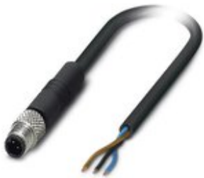
Sensor-/Aktor-Kabel, 3-polig, PUR, schwarz RAL 9005, Stecker gerade M5, Kodierung: A, auf freies Leitungsende, Kabellänge: 3 m
