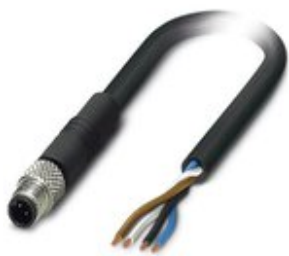
Sensor-/Aktor-Kabel, 4-polig, PUR, schwarz RAL 9005, Stecker gerade M5, Kodierung: A, auf freies Leitungsende, Kabellänge: 3 m
