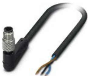
Sensor-/Aktor-Kabel, 3-polig, PUR, schwarz RAL 9005, Stecker gewinkelt M5, Kodierung: A, auf freies Leitungsende, Kabellänge: 1,5 m
