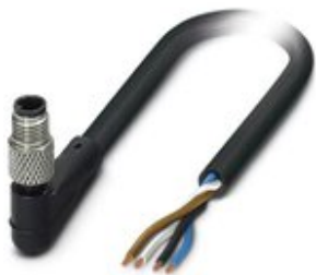
Sensor-/Aktor-Kabel, 4-polig, PUR, schwarz RAL 9005, Stecker gewinkelt M5, Kodierung: A, auf freies Leitungsende, Kabellänge: 10 m
