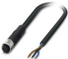
Sensor-/Aktor-Kabel, 3-polig, PUR, schwarz RAL 9005, freies Leitungsende, auf Buchse gerade M5, Kodierung: A, Kabellänge: 1,5 m
