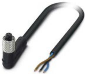
Sensor-/Aktor-Kabel, 3-polig, PUR, schwarz RAL 9005, freies Leitungsende, auf Buchse gewinkelt M5, Kodierung: A, Kabellänge: 10 m
