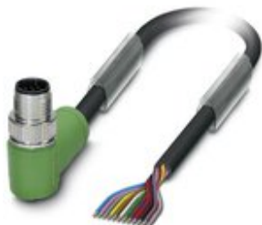
Kabel czujnika/urządzenia wykonawczego, 12-bieg., PCW, czarny RAL 9005, Wtyki kątowe M12 SPEEDCON, kodowanie: A, na wolny koniec przewodu, długość kabla: 3 m
