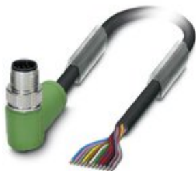
Sensor-/Aktor-Kabel, 12-polig, PVC, schwarz RAL 9005, Stecker gewinkelt M12 SPEEDCON, Kodierung: A, auf freies Leitungsende, Kabellänge: 5 m
