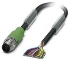
Sensor-/Aktor-Kabel, 17-polig, PVC, schwarz RAL 9005, Stecker gerade M12 SPEEDCON, Kodierung: A, auf freies Leitungsende, Kabellänge: 3 m
