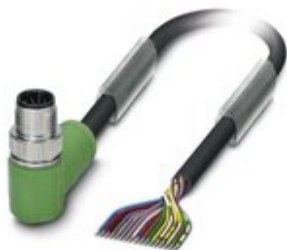
Sensor-/Aktor-Kabel, 17-polig, PVC, schwarz RAL 9005, Stecker gewinkelt M12 SPEEDCON, Kodierung: A, auf freies Leitungsende, Kabellänge: 5 m
