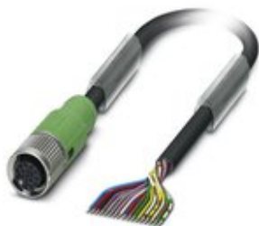
Sensor-/Aktor-Kabel, 17-polig, PVC, schwarz RAL 9005, freies Leitungsende, auf Buchse gerade M12 SPEEDCON, Kodierung: A, Kabellänge: 5 m
