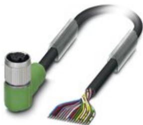
Sensor-/Aktor-Kabel, 17-polig, PVC, schwarz RAL 9005, freies Leitungsende, auf Buchse gewinkelt M12 SPEEDCON, Kodierung: A, Kabellänge: 5 m
