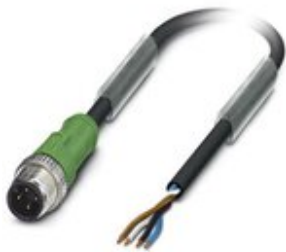
Sensor-/Aktor-Kabel, 4-polig, PUR halogenfrei, schwarzgrau RAL 7021, Stecker gerade M12, Kodierung: A, auf freies Leitungsende, Kabellänge: 3 m
