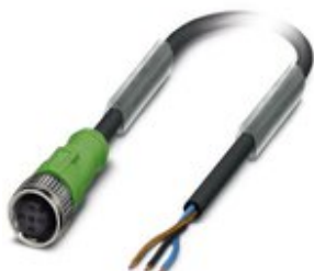
Sensor-/Aktor-Kabel, 3-polig, PUR halogenfrei, schwarzgrau RAL 7021, freies Leitungsende, auf Buchse gerade M12, Kodierung: A, PIN 2+4 gebrückt, Kabellänge: 3 m
