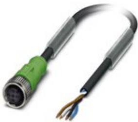
Sensor-/Aktor-Kabel, 4-polig, PUR halogenfrei, schwarzgrau RAL 7021, freies Leitungsende, auf Buchse gerade M12, Kodierung: A, Kabellänge: 5 m
