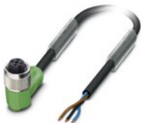
Sensor-/Aktor-Kabel, 3-polig, PUR halogenfrei, schwarzgrau RAL 7021, freies Leitungsende, auf Buchse gewinkelt M12, Kodierung: A, PIN 2+4 gebrückt, Kabellänge: 3 m
