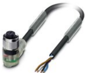
Sensor-/Aktor-Kabel, 4-polig, PUR halogenfrei, schwarzgrau RAL 7021, freies Leitungsende, auf Buchse gewinkelt M12, Kodierung: A, mit 3 LEDs, Kabellänge: 1,5 m
