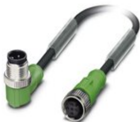
Sensor-/Aktor-Kabel, 3-polig, PUR halogenfrei, schwarzgrau RAL 7021, Stecker gewinkelt M12, Kodierung: A, auf Buchse gerade M12, Kodierung: A, PIN 2+4 gebrückt, Kabellänge: 0,6 m
