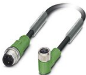
Sensor-/Aktor-Kabel, 3-polig, PUR halogenfrei, schwarzgrau RAL 7021, Stecker gerade M12, Kodierung: A, auf Buchse gewinkelt M8, Kabellänge: 1,5 m
