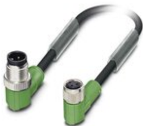
Sensor-/Aktor-Kabel, 3-polig, PUR halogenfrei, schwarzgrau RAL 7021, Stecker gewinkelt M12, Kodierung: A, auf Buchse gewinkelt M8, Kabellänge: 0,3 m
