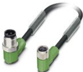
Sensor-/Aktor-Kabel, 3-polig, PUR halogenfrei, schwarzgrau RAL 7021, Stecker gewinkelt M12, Kodierung: A, auf Buchse gewinkelt M8, Kabellänge: 0,6 m
