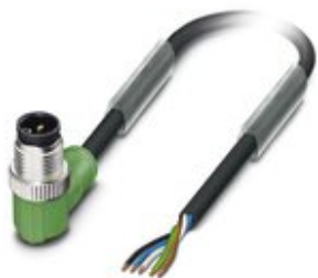
Sensor-/Aktor-Kabel, 5-polig, PUR halogenfrei, schwarzgrau RAL 7021, Stecker gewinkelt M12, Kodierung: A, auf freies Leitungsende, Kabellänge: 3 m
