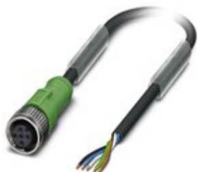
Sensor-/Aktor-Kabel, 5-polig, PUR halogenfrei, schwarzgrau RAL 7021, freies Leitungsende, auf Buchse gerade M12, Kodierung: A, Kabellänge: 5 m
