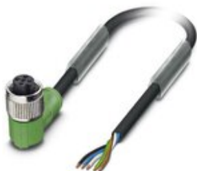
Sensor-/Aktor-Kabel, 5-polig, PUR halogenfrei, schwarzgrau RAL 7021, freies Leitungsende, auf Buchse gewinkelt M12, Kodierung: A, Kabellänge: 1,5 m
