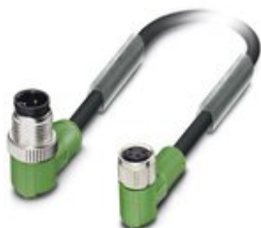
Sensor-/Aktor-Kabel, 4-polig, PUR halogenfrei, schwarzgrau RAL 7021, Stecker gewinkelt M12, Kodierung: A, auf Buchse gewinkelt M8, Kabellänge: 0,3 m
