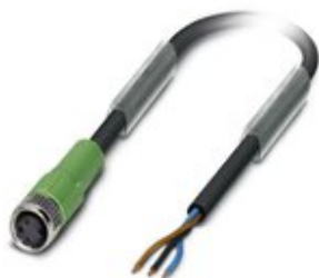
Sensor-/Aktor-Kabel, 3-polig, PUR halogenfrei, schwarzgrau RAL 7021, freies Leitungsende, auf Buchse gerade M8, Kabellänge: 1,5 m
