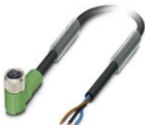
Sensor-/Aktor-Kabel, 3-polig, PUR halogenfrei, schwarzgrau RAL 7021, freies Leitungsende, auf Buchse gewinkelt M8, Kabellänge: 1,5 m
