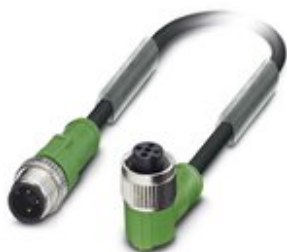
Sensor-/Aktor-Kabel, 3-polig, PUR halogenfrei, schwarzgrau RAL 7021, Stecker gerade M12, Kodierung: A, auf Buchse gewinkelt M12, Kodierung: A, Kabellänge: 0,3 m
