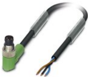
Sensor-/Aktor-Kabel, 3-polig, PUR halogenfrei, schwarzgrau RAL 7021, Stecker gewinkelt M8, auf freies Leitungsende, Kabellänge: 3 m
