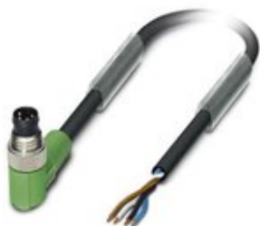
Sensor-/Aktor-Kabel, 4-polig, PUR halogenfrei, schwarzgrau RAL 7021, Stecker gewinkelt M8, auf freies Leitungsende, Kabellänge: 5 m
